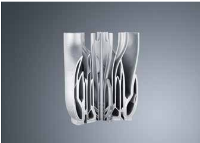
LMF 可用于生成复杂的内部结构, 比如这个燃烧器头部 (西门子)。
