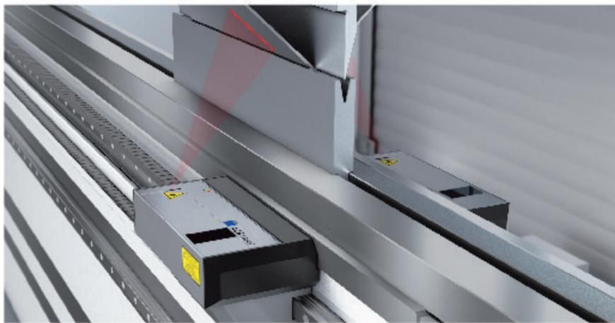
光学角度控制系统 ACB Laser
